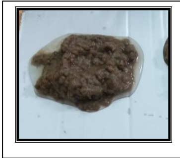
شكل ( ٦-٣ ) هرس القصب
