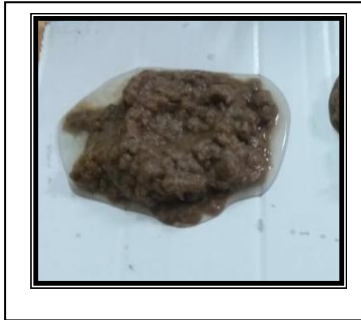
شكل ( ٦-٣ ) هرس القصب
